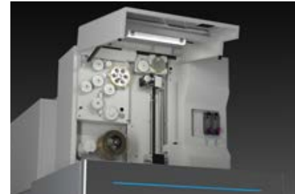
機内照明灯 LED 照明
