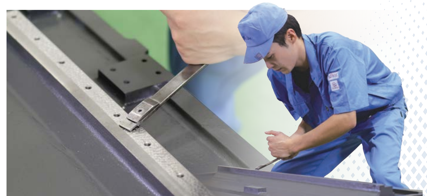
伝統の技 ～きさげ作業～
